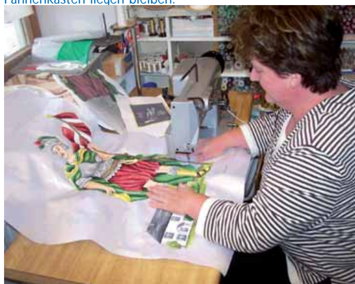
Das Mittelmotiv "Heiliger Florian" wird mit einer handgeführten Maschine gestickt.
